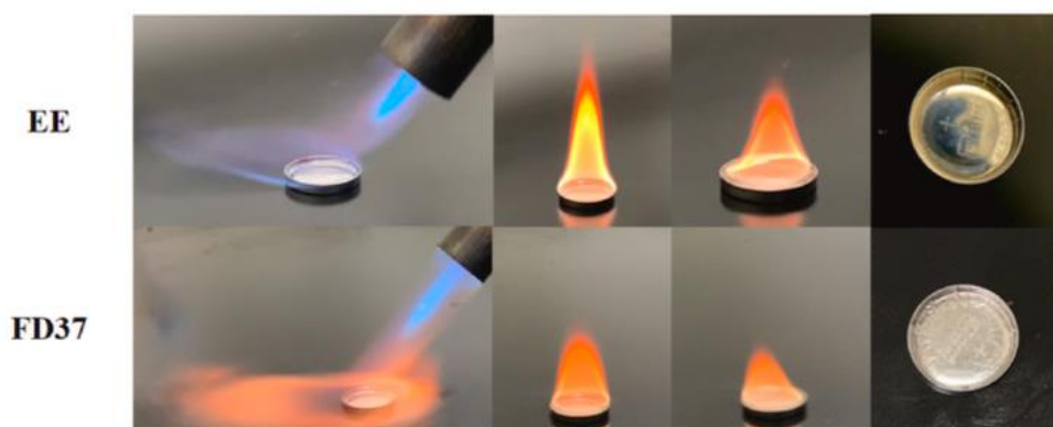
รูปที่ 2.15 การทดสอบ SET ของสารละลายอิเล็กโทรไลต์ EE (บน) และ FD37 (ล่าง) [56]
