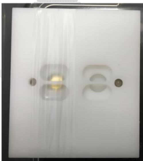
รูปที่ 4.7 ชุดสำหรับการทำการดัดแปลงควิซีเอ็มเซนเซอร์
