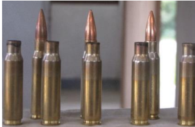
รูปที่ 2.13 กระสุน 7.62X51 มม. FMJ NATO ตามมาตรฐาน NIJ ในระดับที่ 3
