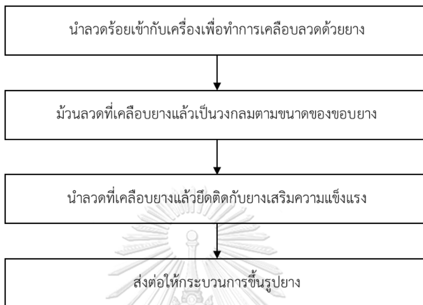
รูปที่ 17 ขั้นตอนการเตรียมขอบยาง (Bead)
