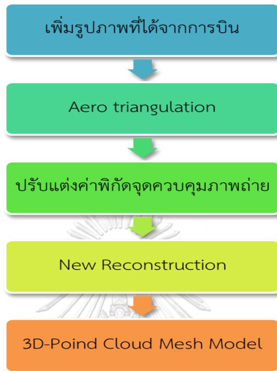
รูปที่ 24 กระบวนการประมวลผลโปรแกรม Context Capture
