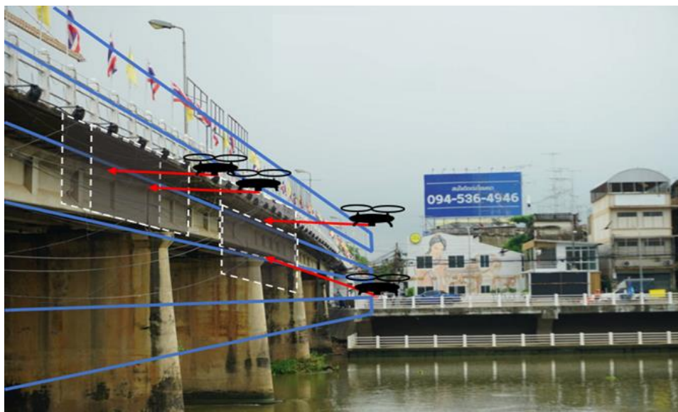
รูปที่ 19 รูปแบบการบินส่วนด้านข้างของสะพาน
