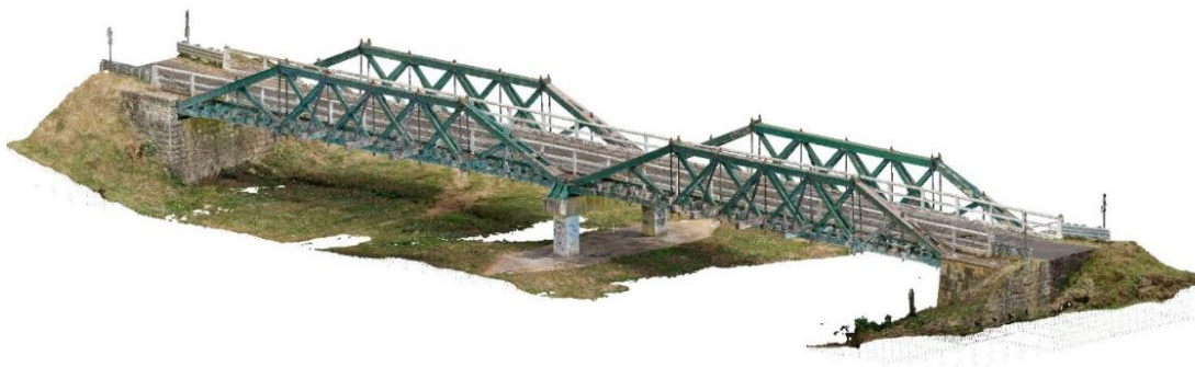
รูปที่ 9 แบบจำลองที่ได้จากอากาศยานไร้คนขับ(UAV)
