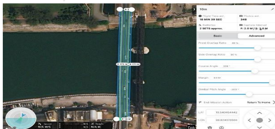
รูปที่ 18 รูปแบบการบินส่วนบนของสะพานโดยโปรแกรม DJI GS Pro
