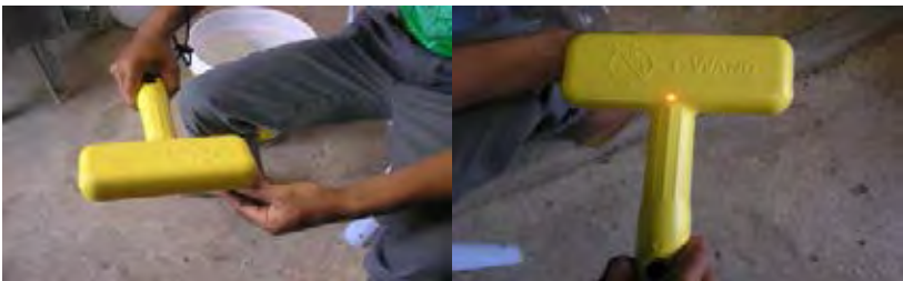
รูปที่ 3.13 เครื่องตรวจหาเครื่องหมายที่ติดบนลูกปูในภาคสนาม (Handheld Wand Detector) แบบ T-Bar
