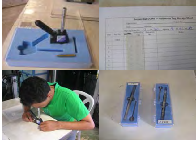
รูปที่ 3.10 เครื่องมือสำหรับติดเครื่องหมาย (sequential codes wire tags) ในลูกปูก่อนการปล่อยลูกปูในธรรมชาติประกอบด้วยเครื่องหมายชนิดเรียงเลขรหัสและเครื่องติดเครื่องหมายแบบ Single Shot Tag Injector
