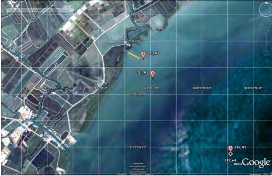
รูปที่ 1.11 จุดตรวจวัดคลื่น (รูปหยดน้ำ 1, 2, และ 3) ดักตะกอน (ศรีเหลียมข้าวหลามตัด) และการเปลี่ยนแปลงระดับท้องน้ำ (แนวเส้นตรง) ที่ปากคลองหมื่นหาญ ตำบลบางแก้ว จังหวัดสมุทรสงคราม
