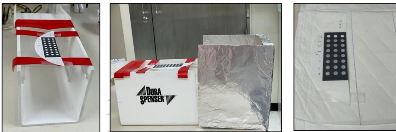
รูปที่ 13 แสดงลักษณะอุปกรณ์ที่ใช้ในการยึดติด ครอบกระดาษ และแผ่นซับขณะหยดล้าง
