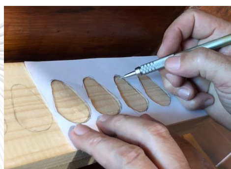
ภาพที่ 287 ร่างแบบฐานกระบอกสูบบนแผงไม้ ที่มา : ผู้วิจัย
