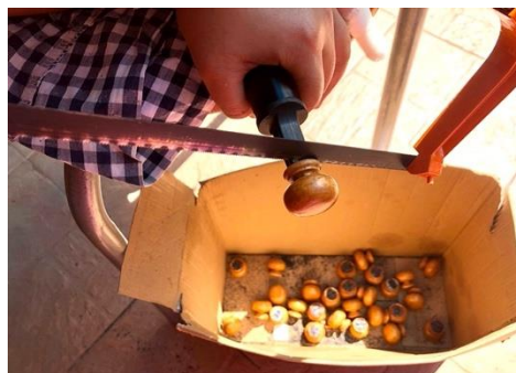
ภาพที่ 307 เลื่อยแป้นกดไม้อันเก่าออก ที่มา : ผู้วิจัย
