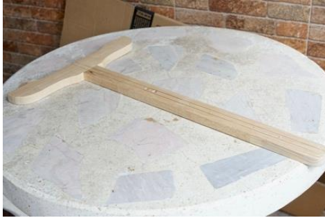
ภาพที่ 160 ไม้เสาที่ทำแนวเซาะร่องแล้ว ที่มา : ผู้วิจัย
