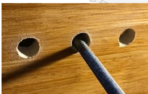
ภาพที่ 198 ขัดแต่งรูด้วยตะไบกลม ที่มา : ผู้วิจัย
