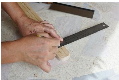
ภาพที่ 158 ใช้ดินสอลากเส้นเพื่อทำแนว 2 ที่มา : ผู้วิจัย
