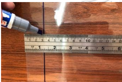
ภาพที่ 222 กำหนดขนาดแผ่นใส ที่มา : ผู้วิจัย
