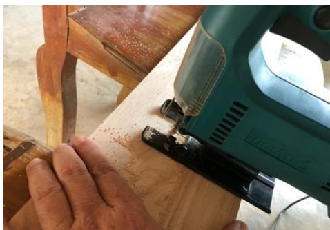
ภาพที่ 146 เลื่อยไม้ด้วยเลื่อยจิ๊กซอว์ ที่มา : ผู้วิจัย
