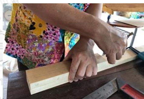
ภาพที่ 229 กำหนดตำแหน่งตัดไม้ ที่มา : ผู้วิจัย
