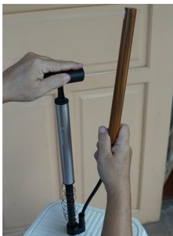
ภาพที่ 44 ทดสอบการทำงานของระบบลูกสูบ
