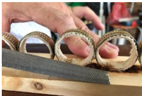
ภาพที่ 181 ชัดกาวร้อนและฝังไม้ด้วยตะไบ ที่มา : ผู้วิจัย
