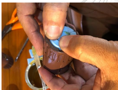
ภาพที่ 324 ใส่แผ่นโฟมในข้อต่อ
