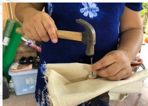
ภาพที่ 132 ใช้ตะปูเจาะนำศูนย์
