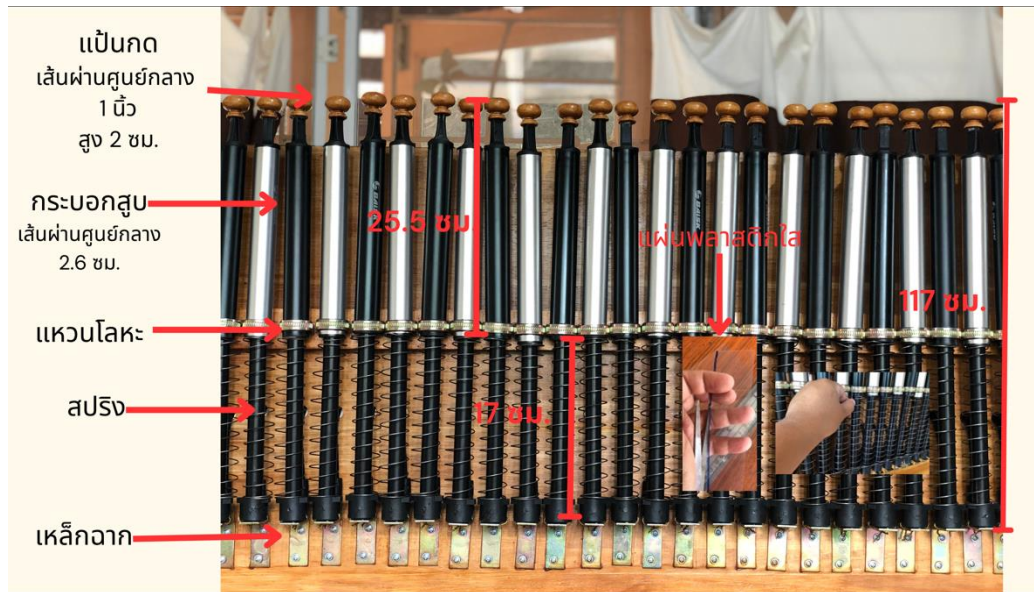
ภาพที่ 54 สัดส่วนและส่วนประกอบระบบลมภายในของลมรายที่พัฒนา ครั้งที่ 2 ที่มา : ผู้วิจัย
