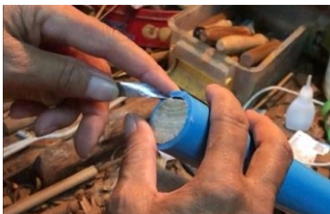
ภาพที่ 78 กำจัดเศษไม้ด้วยมีด ที่มา : ผู้วิจัย
