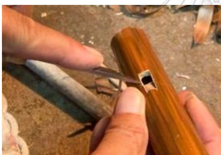
ภาพที่ 63 การแกะปากนกแก้วท่อขนาดเล็ก ที่มา : ผู้วิจัย
