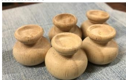
ภาพที่ 134 แป้นไม้ที่คว้านเนื้อไม้แล้ว
