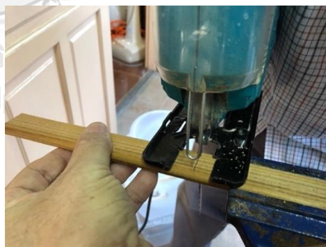
ภาพที่ 321 ตัดแผ่นไม้ขนاب
