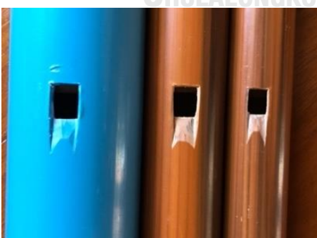
ภาพที่ 65 ท่อลมรายชื่อที่แกะปากนกแก้วเสร็จแล้ว ที่มา : ผู้วิจัย
