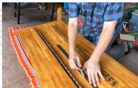
ภาพที่ 196 ชีดเส้นทำแนวเจาะสายลม ที่มา : ผู้วิจัย
