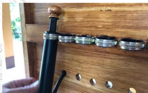
ภาพที่ 203 สวมกระบอกสูบเข้ากับแหวนโลหะ ที่มา : ผู้วิจัย
