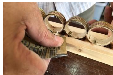
ภาพที่ 182 ชัดกาวร้อนและฝังไม้ด้วยกระดาษทราย ที่มา : ผู้วิจัย
