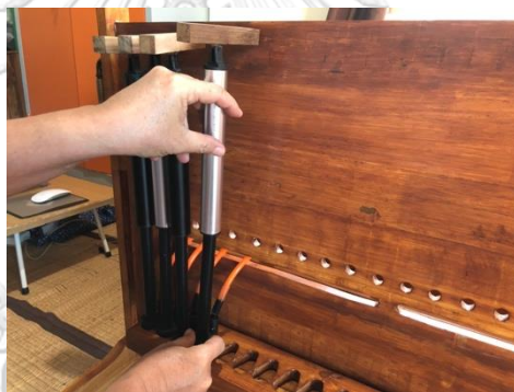
ภาพที่ 303 ประกอบกระบอกสูบลมเข้ากับตัวเรือน
