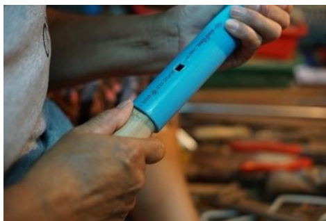
ภาพที่ 71 ทดลองใส่ไม้ดากเข้ากับท่อลมราย ที่มา : ผู้วิจัย
