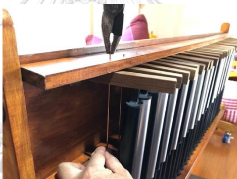
ภาพที่ 318 สอดลวดเข้ากับแผงไม้และแป้นกด
