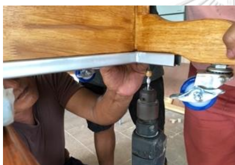
ภาพที่ 250 ยึดตะปูเกลียวที่คานเหล็ก ที่มา : ผู้วิจัย
