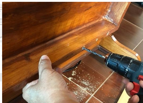
ภาพที่ 285 ใช้สว่านเจาะรูฐานกล่องไม้เดิม ที่มา : ผู้วิจัย
