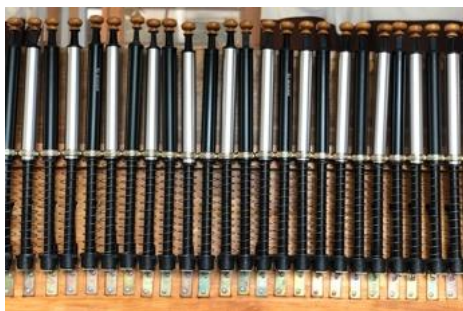
ภาพที่ 206 ยึดกระบอกสูบกับเหล็กฉาก
