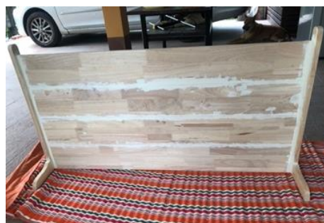
ภาพที่ 169 ตัวเรือนที่อุดโป๊วเสร็จแล้ว
