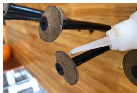
ภาพที่ 214 หยอดกาวร้อนที่ด้านหลังของหนัง ที่มา : ผู้วิจัย
