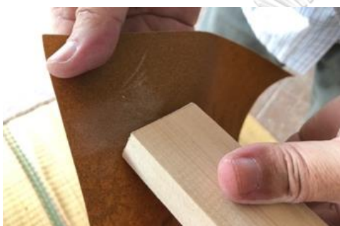
ภาพที่ 186 ลบความคมสันไม้ ที่มา : ผู้วิจัย
