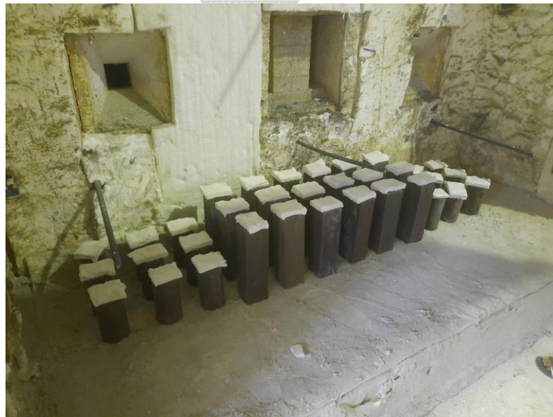
รูปที่ 60 คอนกรีตกระตุ่นด้วยด่างทำการทดสอบเผาไฟที่ระยะเวลา 60 นาที
