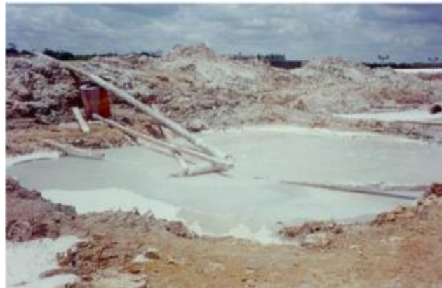
รูปที่ 7 บ่อโคลนของกากจากการตัดหินแกรนิต (Bacarji et al., 2013)
