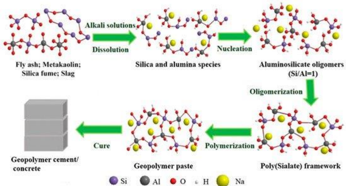
รูปที่ 4 กระบวนการเกิดวัสดุจีโอโพลิเมอร์ (Shamsaei et al., 2021)
