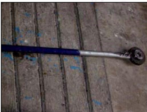
รูป ก-22 ก้านโยกกระดานสร้างคลื่น และมอเตอร์ไฟฟ้า
