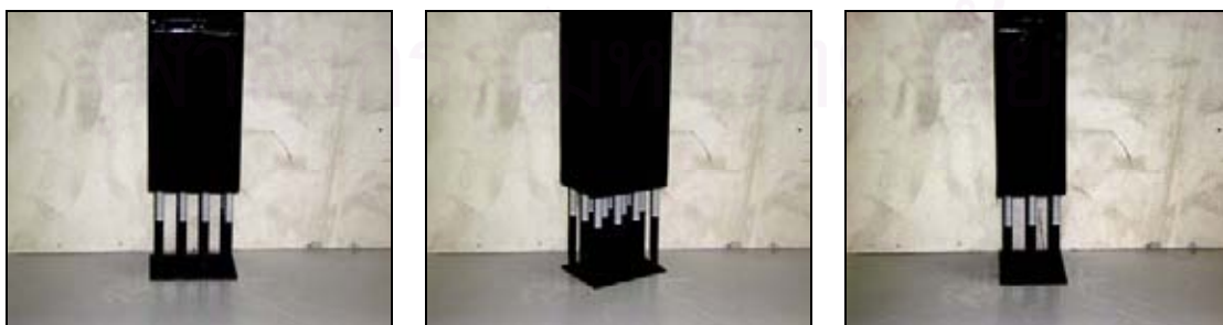
รูป ก-19 แบบจำลองตอม่อ กรณีศึกษา P10 : t_s = 1.0y_0
