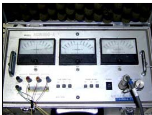
ข) อุปกรณ์รับสัญญาณอนาล็อกเครื่องวัดกระแส
