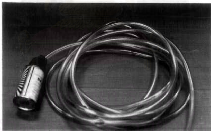
รูปที่ 4.12 อุปกรณ์ที่ใช้ในการถ่ายภาพด้วยนิวตรอนสำหรับชิ้นงานที่เคลื่อนที่
