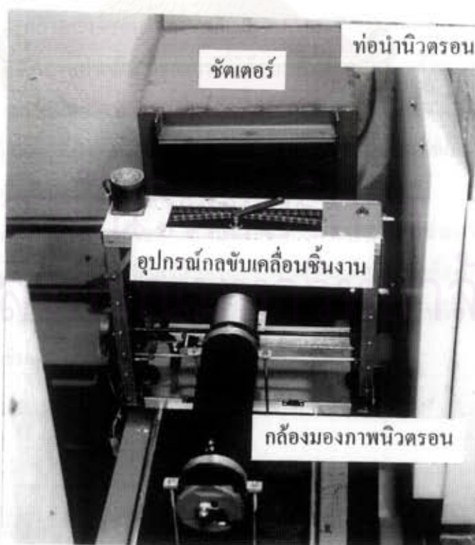
รูปที่ 4.5 การจัดอุปกรณ์ระบบถ่ายภาพด้วยนิวตรอนโดยใช้กล้องมองภาพนิวตรอน
