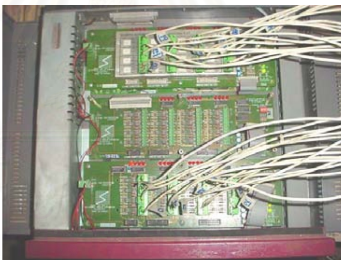
รูปที่ 3.2 เครื่องมือวัดอุณหภูมิ (Data Logger) รุ่นเครื่อง SYSTEM 200
