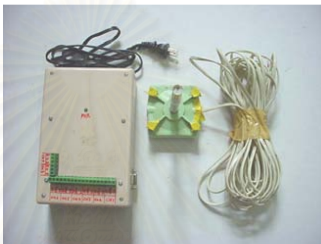
รูปที่ 3.3 เครื่อง Data Logger พร้อมหัววัดความเร็วลม
