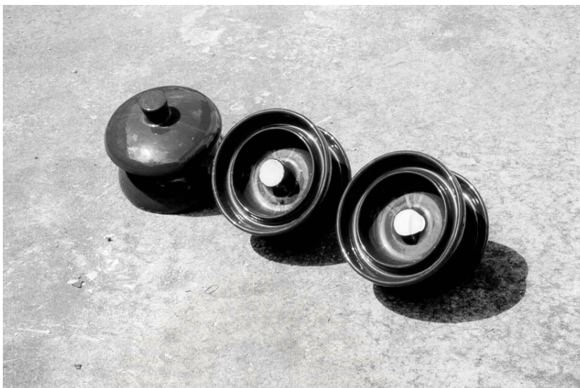
รูปที่ 5.16 ลักษณะลูกถ้วยหลังการทดสอบแรงดึงทางกลครั้งที่ 2
