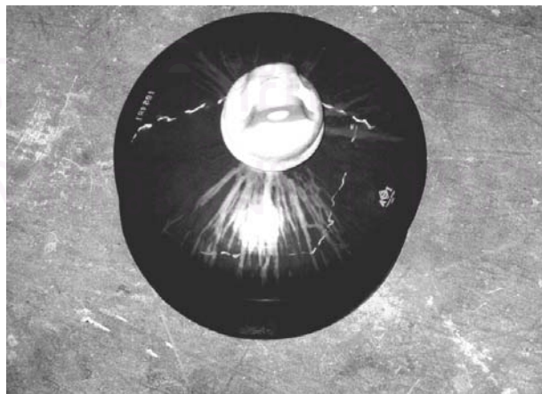
รูปที่ 5.12 ลักษณะผิวลูกถ้วยแขวนคู่คอดันแบบสอง หลังการทดสอบเจาะทะลุ
