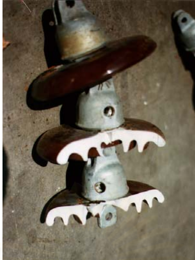
รูปที่ 3.5 พวงลูกถ้วยแขวน ANSI Class 52-4 เจาะทะลุหลังจากได้รับแรงดันเกินเสิร์จฟ้าผ่า
