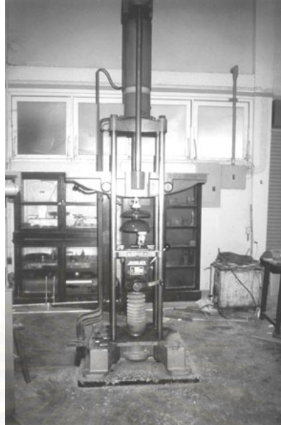
รูปที่ 5.14 ลูกถ้วยแขวนคู้คอตันประกอบที่ยึดโลหะเข้ากับ เครื่องดึงแรงกลขนาดพิกัด 40 ตัน
