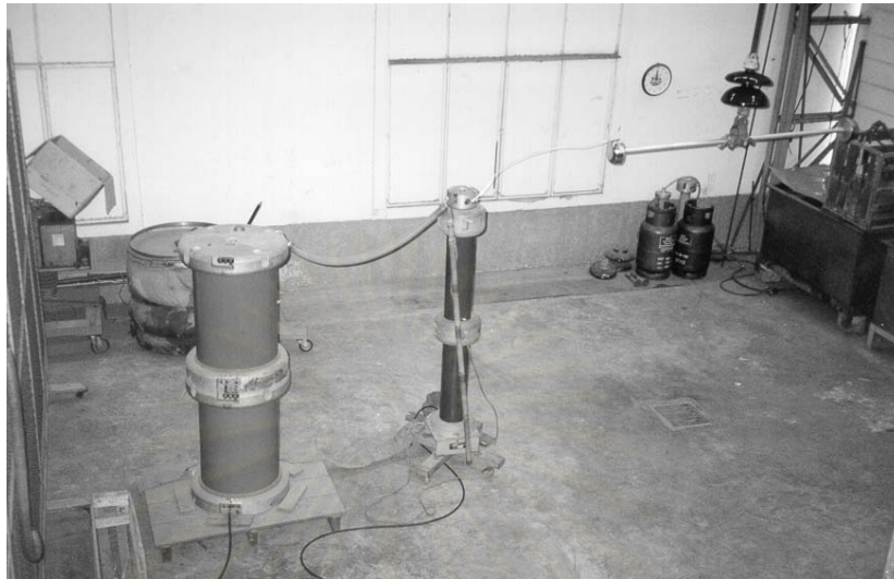
รูปที่ 5.3 วงจรทดสอบแรงดันวาทไฟตามผิวความถี่ 50 Hz ในสภาวะแห้ง
