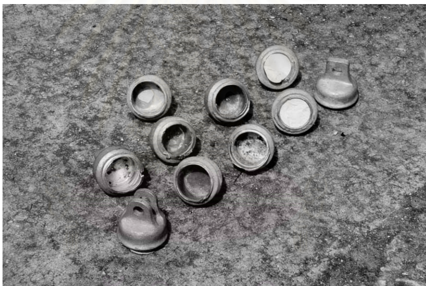
รูปที่ 5.17 ลักษณะหัวครอบโลหะลูกถ้วยหลังการทดสอบแรงดึงทางกล (ซ้าย : เกิดการหลุดออกจากตัวลูกถ้วย, ขวา : เกิดการหักบริเวณคอใกล้หัวครอบโลหะ)
