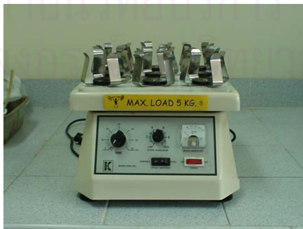
รูปที่ 3 เครื่องเขย่าที่ใช้ในการศึกษาปัจจัยที่มีอิทธิพลต่อการดูดติดผิว
