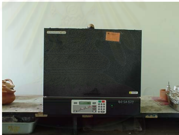
รูปที่ 2 เตาเผาที่ใช้ในการเตรียมถ่านกัมมันต์
