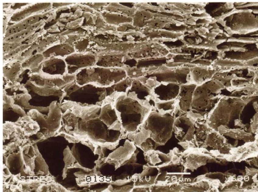
ข. แสดงโครงสร้าง และพื้นผิว ของถ่านเปลือกทุเรียนที่ใช้สารกระตุ้นเกลือแกงอัตราส่วนวัตถุดิบ ต่อเกลือ 1:0 เมื่อใช้กำลังขยาย 600 เท่า
