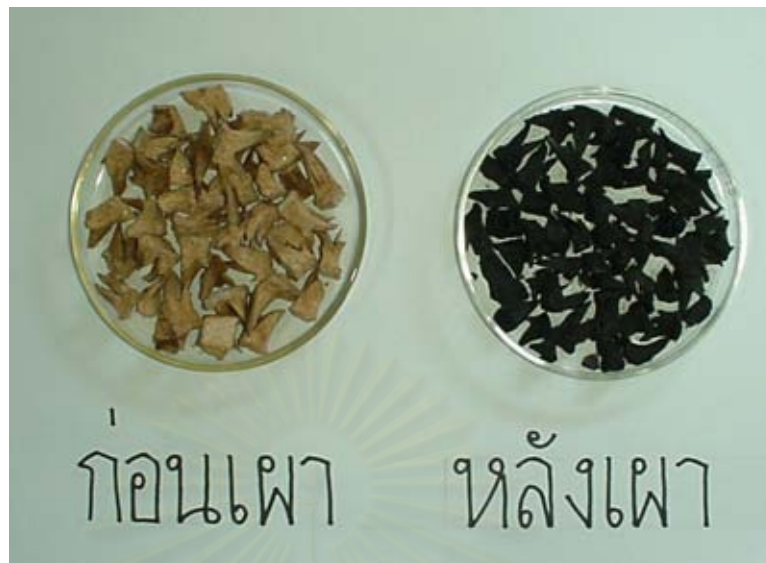
รูปที่ 4.1 ตัวอย่างเปลือกทุเรียนเปรียบเทียบก่อน และหลังการเผาให้เป็นถ่านและการกระตุ้น
