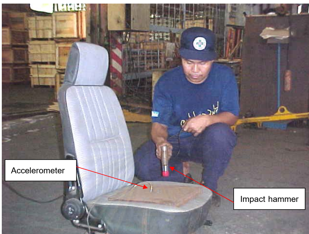
รูปที่ 3.12 อุปกรณ์การวัดค่าสัมประสิทธิ์ความแข็งแรงของเบาะนั่ง
