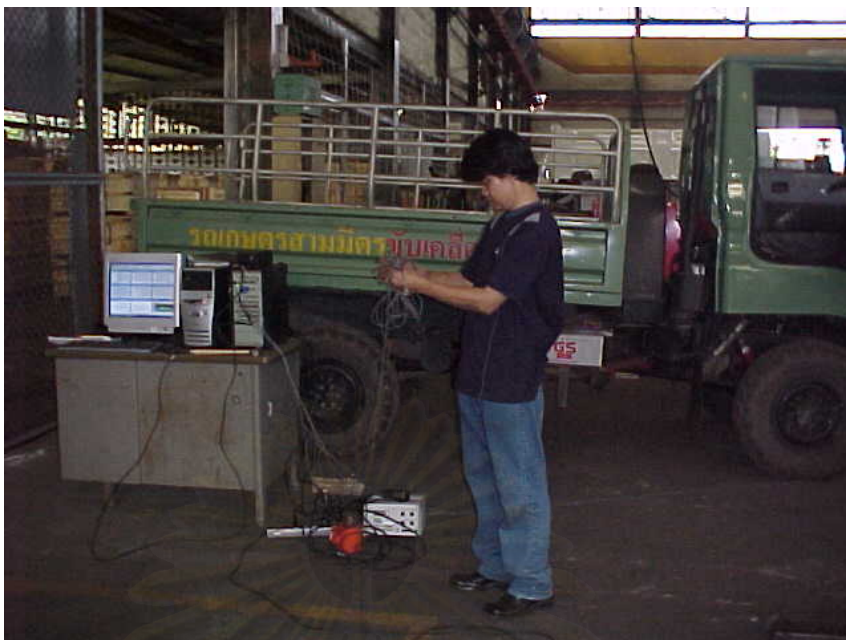
รูปที่ 2. ค. การต่อสายจากเครื่อง Pulse analyzer แล้วนำ Accelerometer ไปติดตั้งที่รถยนต์
