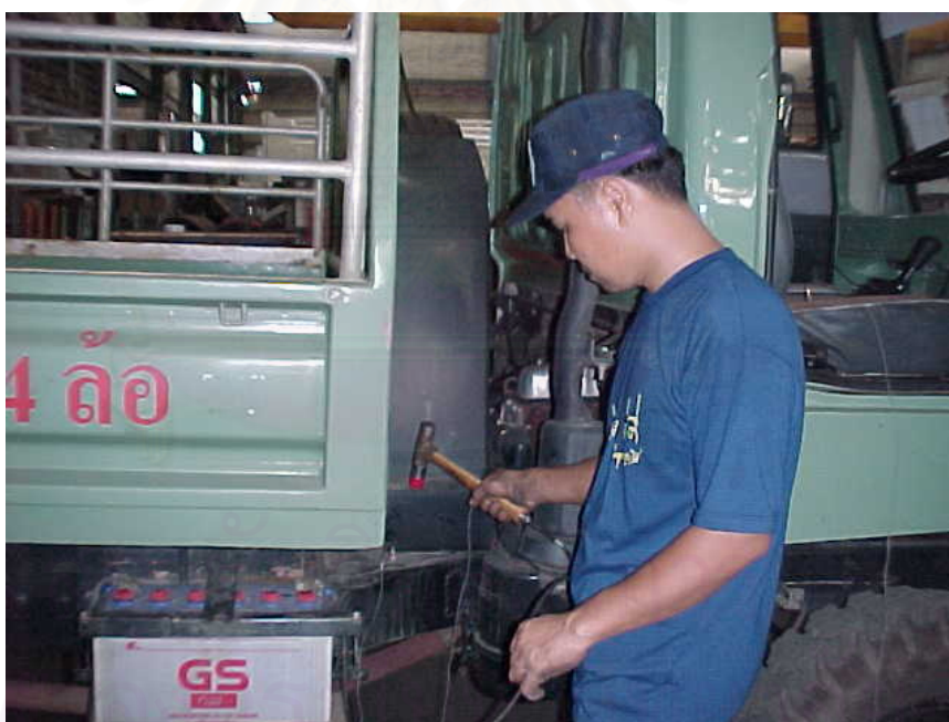
รูปที่ 3. ค. การการใช้ค้อนเคาะที่ตำแหน่งใกล้ Accelerometer
