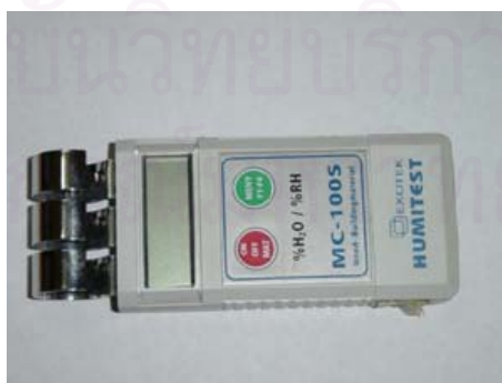
ภาพที่ 3-3 แสดงเครื่องมือวัดความชื้นที่ผิววัสดุ
