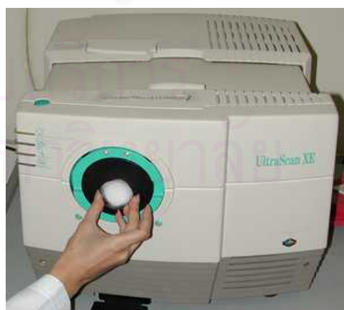
รูปที่4 สารแต่งสีทั้ง 4 ชนิดที่ใช้ทดสอบ รูปที่5 แสดงการวัดสีวัสดุด้วยเครื่อง อัลตรา สแกน เอกซ์ อี
