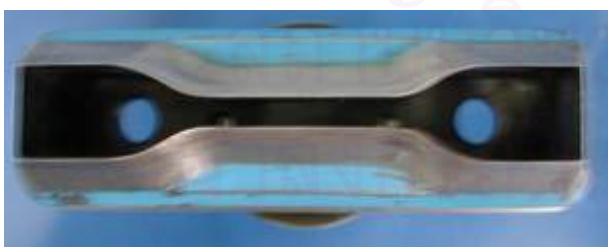
รูปที่ 11a แสดงหัวตัดขึ้นทดสอบโลหะ ISO 37 แบบที่ 2
