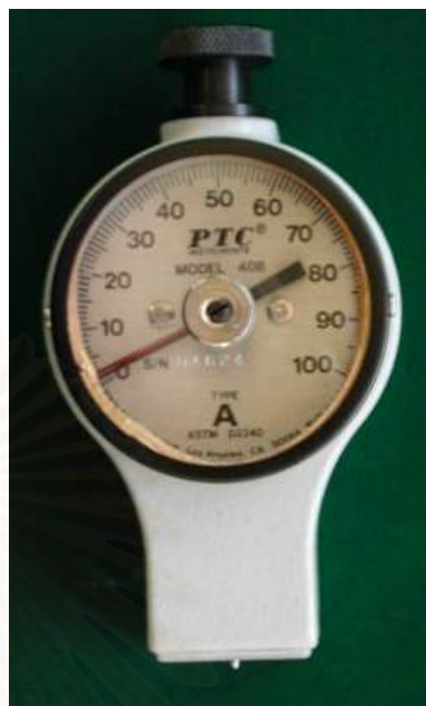
รูปที่ 20a เครื่องวัดความแข็งผิวประกอบด้วยขาตั้งรุ่น 471 รูปที่ 20b หัวทดสอบรุ่น 408
