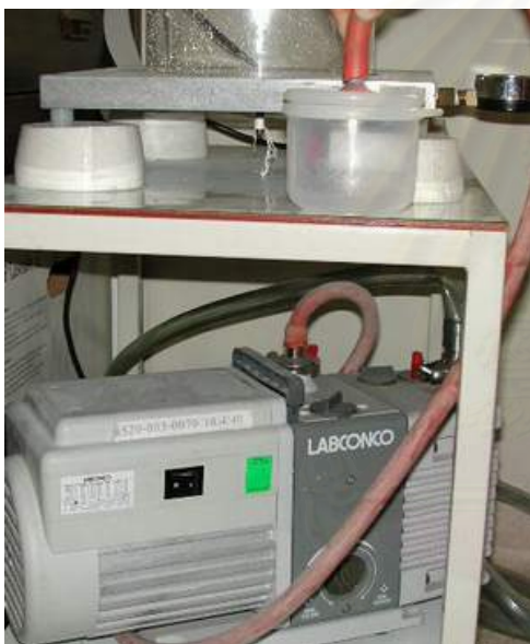
รูปที่ 7 แสดงการต่อภาชนะเข้ากับเครื่องดูดสุญญากาศ
