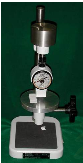
รูปที่ 20a เครื่องวัดความแข็งผิวประกอบด้วยขาตั้งรุ่น 471 รูปที่ 20b หัวทดสอบรุ่น 408
