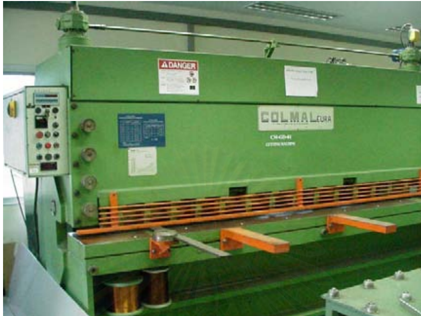
รูปที่ 4.6 แสดงการตัดแผ่น Copper Clade ด้วยเครื่องตัดโลหะแผ่น
