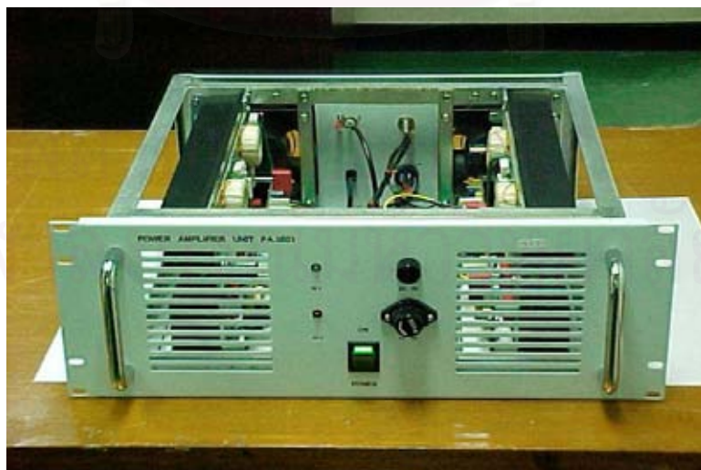
รูปที่ 4.12 แสดงการ Wiring และประกอบลง Module
