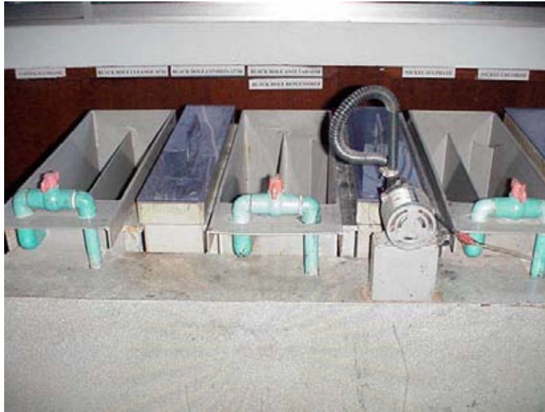
รูปที่ 4.8 แสดงกระบวนการชุบแผ่น Copper Clade ในบ่อชุบ
