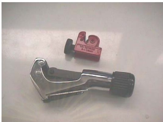
รูปที่ 3-8 แสดงภาพอุปกรณ์ที่ใช้ตัดท่อทองแดงขนาดต่างๆ
