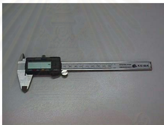
รูปที่ 3-9 แสดงภาพอุปกรณ์ที่ใช้วัดขนาดท่อและความหนาต่างๆ
