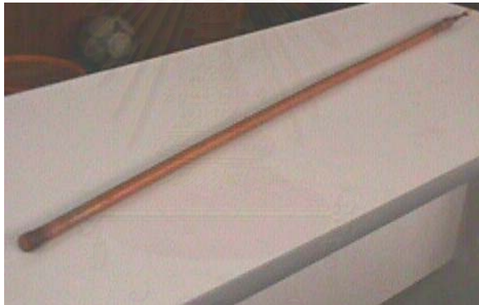
สถาบันวิทยบริการ รูปที่ 3-2 แสดงแบบของฮีตไปป์ที่ทำการประกอบเสร็จแล้ว จุฬาลงกรณ์มหาวิทยาลัย
