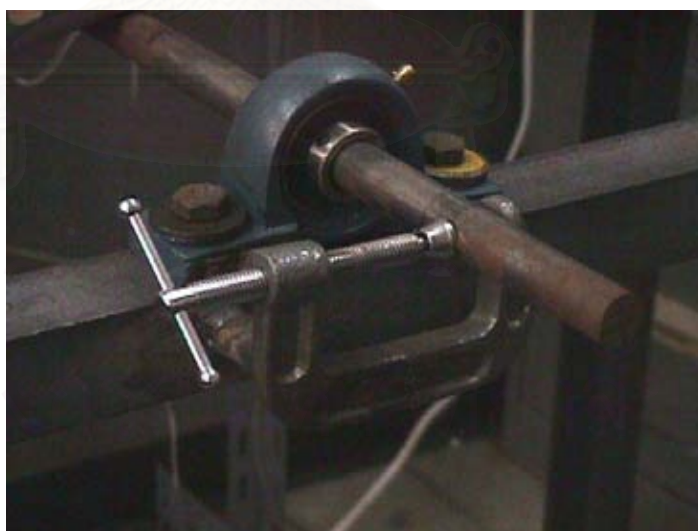
รูปที่ 3-19 แสดงภาพอุปกรณ์ที่ทำการจับยึดให้ฮีตไปป์ทดสอบได้ทุกมุมทดสอบ
