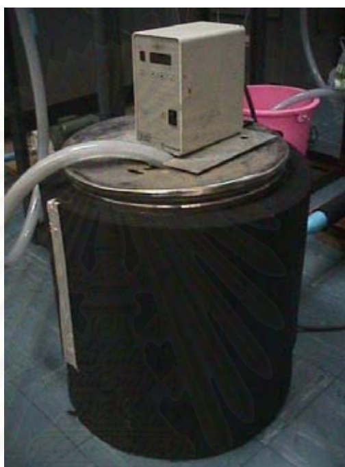
รูปที่ 3-20 แสดงภาพอุปกรณ์ที่ให้ความร้อนในส่วนของการทำระเหย
