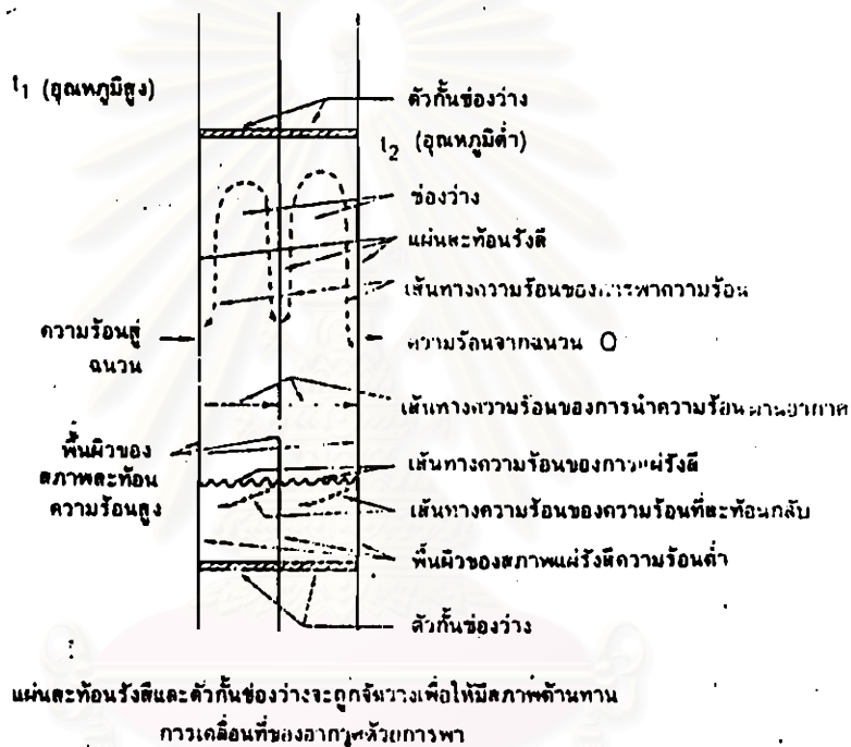
รูปที่ 2.8 แสดงรูปแบบการถ่ายเทความร้อนผ่านฉนวนผิวสะท้อนรังสี ที่มา ตระการ ก้าวกลีกรรม , คู่มือฉนวนความร้อน (2537)
