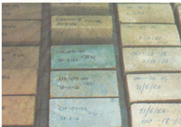
ภาพที่ 2.4 แสดงอิฐดินซีเมนต์เพื่อการทดสอบแรงกดอัดบนชิ้นวัสดุ
