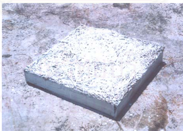
ภาพที่ 4.6 แสดงผนังทดสอบจากฟางข้าวเชื่อมประสานด้วยกาวแป้งข้าวเหนียวและปูนขาว
