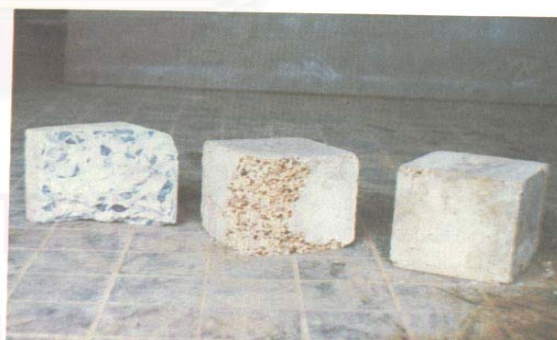
เปรียบเทียบเนื้อคอนกรีตมาตรฐานและเนื้อคอนกรีตถูกรัง
