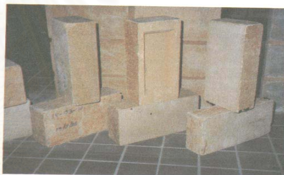
อิฐดินซีเมนต์ขนาด 9x14x29 และ 7x14x29 แบบต่าง ๆ
