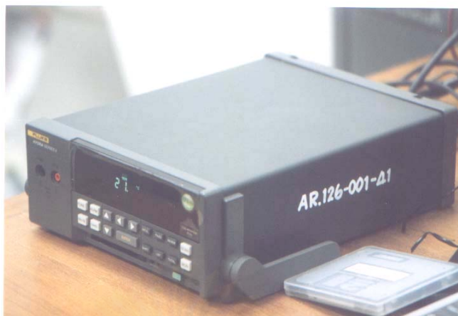
ภาพที่ 3.1 แสดงเครื่องวัดอุณหภูมิ Fluke Hydra logger
