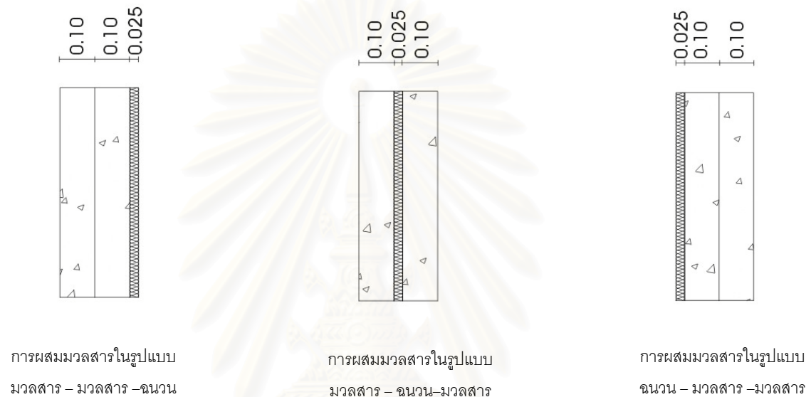
ภาพที่ 2.19 แสดงการทดสอบผนังประกอบ แบบต่าง ๆ
