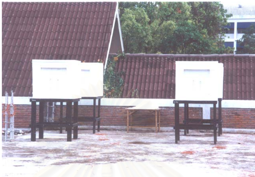
ภาพที่ 4.3 แสดงการวัดอุณหภูมิในส่วนต่าง ๆ ของกล่อง ทดลองวัสดุพื้นถิ่นความหนาแน่นสูง
