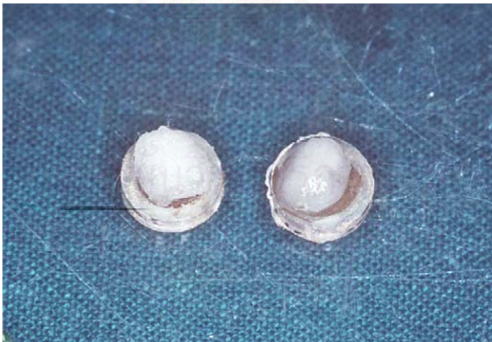
ภาพที่ 9 แสดงการใช้สำลีขนาดเล็กชุบน้ำกลั่นวางบนพื้นผิวของวัสดุ ขณะรอให้วัสดุแข็งตัวเต็มที่
