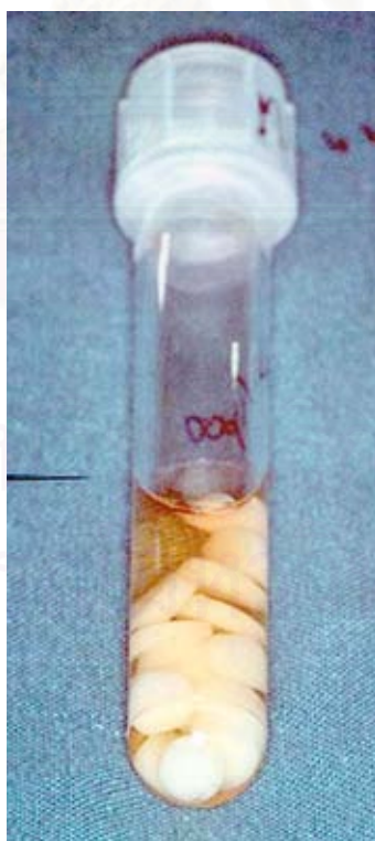
ภาพที่ 17 แสดงการสกัดวัสดุกลาสไอโอโนเมอร์ซีเมนต์ชนิดดัดแปลงด้วยเรซิน โดยการแช่วัสดุในอาหารเลี้ยงเชื้อที่ปราศจากซีรัม
