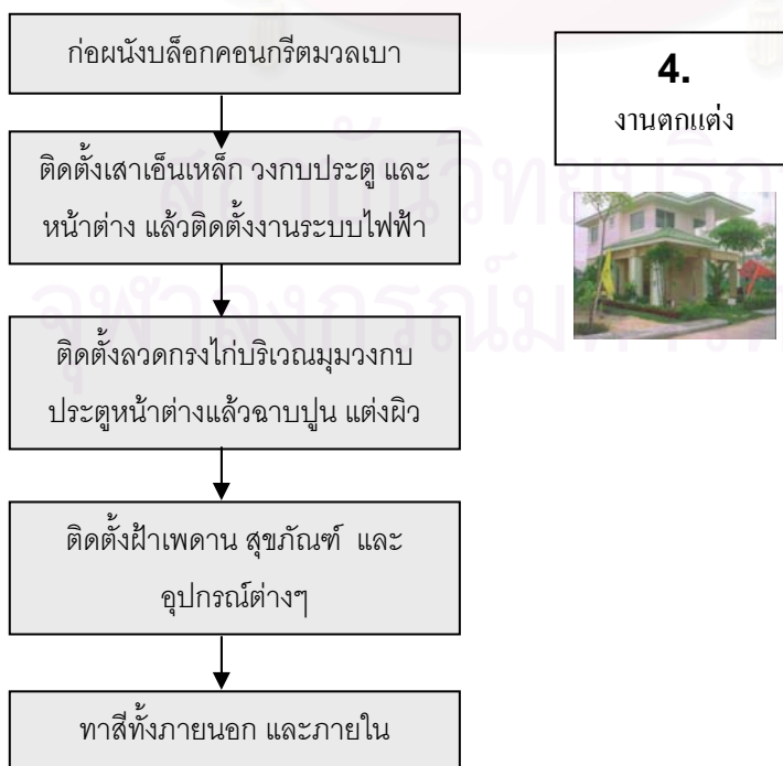
แผนภูมิที่ 5-1 แสดงขั้นตอนการก่อสร้างบ้านด้วยระบบโครงสร้างเหล็ก
