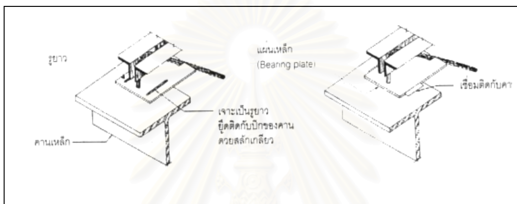
ตัวอย่างรอยต่อโครงหลังคาเหล็ก (Roof joist) กับคานเหล็ก
