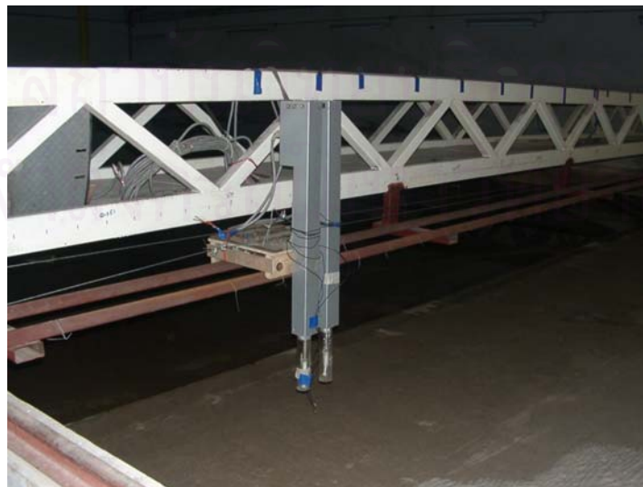
รูปที่ 3-4 เครื่องวัดระดับท้องน้ำ (Sandy surface meter)
