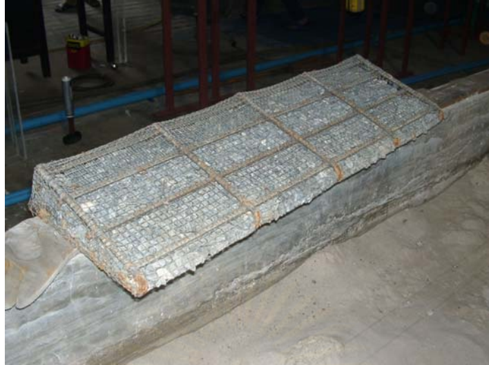
รูปที่ 3-2 แบบจำลองเขื่อนกันคลื่น
