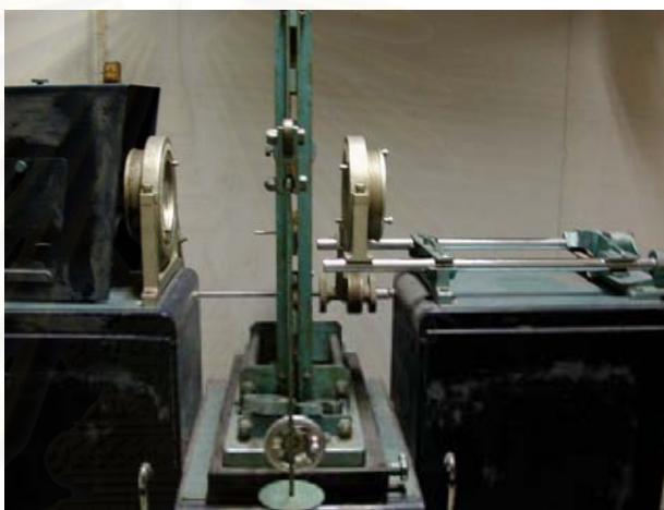
รูปที่ 22 แสดงเครื่องมือเซอร์คิวลาร์โพลาไรสโคป
