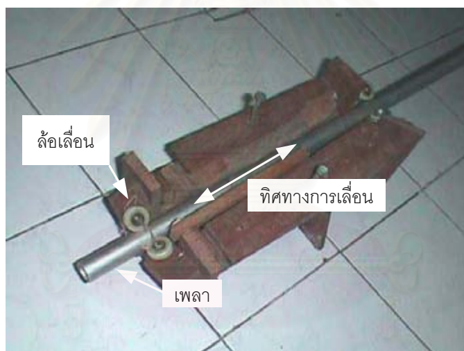
รูปที่ 3.12 แบบจำลองข้อต่อเลื่อนที่จะนำมาใช้กับแขนกลนำ
