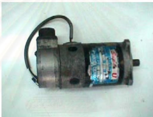
รูปที่ ก.1 เซอร์โวมอเตอร์กระแสตรงรุ่น U825-002E
