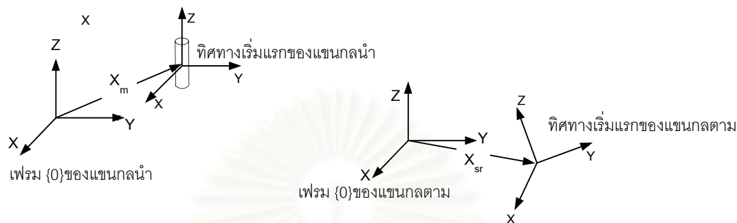
รูปที่ 6.2 แสดงทิศทางที่ปลายแขนกลนำและตามตำแหน่งเริ่มแรก
