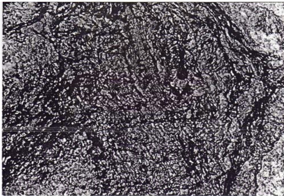
รูป T 5-28 และ T 5-29 ภาพจากกล้องจุลทรรศน์แสดงการโค้งงอชันบันได (Kink fold) ของรอยแตกถี่ (cleavage) ในหินฟิลไลต์ ซึ่งควรเรียกหินฟิลโลไนต์ หรือ Phyllonite) ที่หินเปลี่ยนสภาพเป็นแร่ เก็บตัวอย่างจากพิกัดที่ QPV 30214-59498 (ใช้แสงโพลาไรส์, ปิดนิโคลส์กรองแสง ความยาวภาพประมาณ 4 มม)
