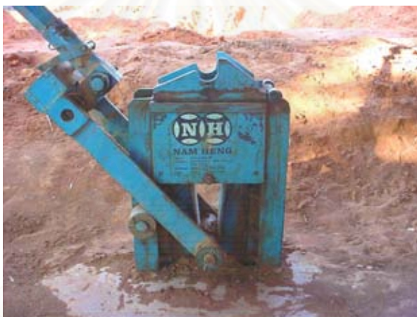
ภาพที่ 4-12 (ข) แสดงเครื่องอัดไฮดรอลิกที่ใช้ผลิตอิฐดินซีเมนต์ ซึ่งมีขนาดเล็ก ราคาไม่สูงมาก สามารถจะทำการผลิตในกลุ่มชุมชนขนาดเล็กได้
