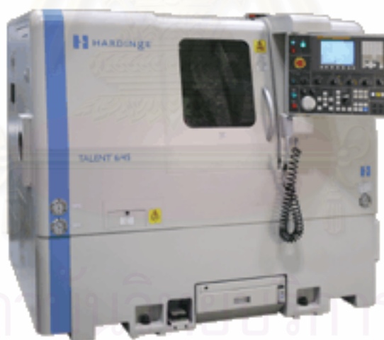
รูปที่ 3.10 เครื่องกลึง Turning ที่ใช้ในการผลิตรากฟันเทียม
