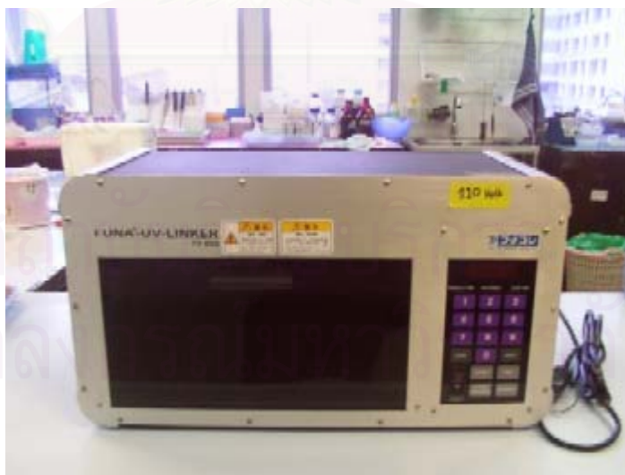
รูปที่ 5 เครื่องอัลตราไวโอเล็ต สำหรับทำแคลเซียมไฮดรอกไซด์ให้ปราศจากเชื้อ
