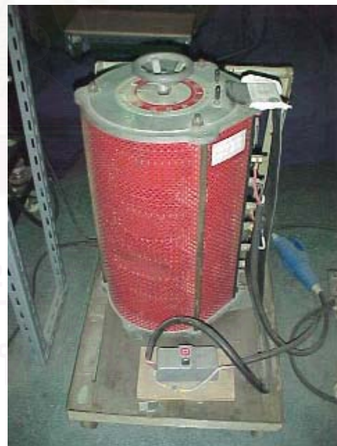
รูปที่ 2.10 ส่วน Heating chamber ของชุดเจ็ดแบบท่อหมุน (ก) รูป Schematic (ข) ภาพถ่ายแสดงการประกอบเข้ากับท่อหมุน (ค) ภาพถ่ายแสดงส่วนประกอบภายใน (ง) หม้อแปลงไฟฟ้าแบบ Variac ที่ใช้สำหรับ Heater
