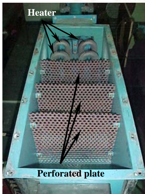
รูปที่ 2.10 ส่วน Heating chamber ของชุดเจ็ดแบบท่อหมุน (ก) รูป Schematic (ข) ภาพถ่ายแสดงการประกอบเข้ากับท่อหมุน (ค) ภาพถ่ายแสดงส่วนประกอบภายใน (ง) หม้อแปลงไฟฟ้าแบบ Variac ที่ใช้สำหรับ Heater
