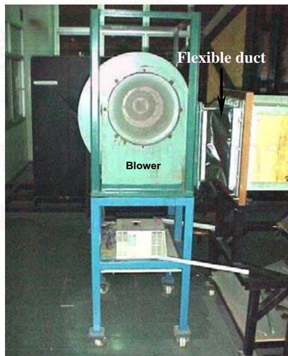
รูปที่ 2.2 พัดลมทอยโข่ง (Centrifugal Blower) ขนาด 2.2 กิโลวัตต์ที่ใช้ในอุโมงค์ลม
