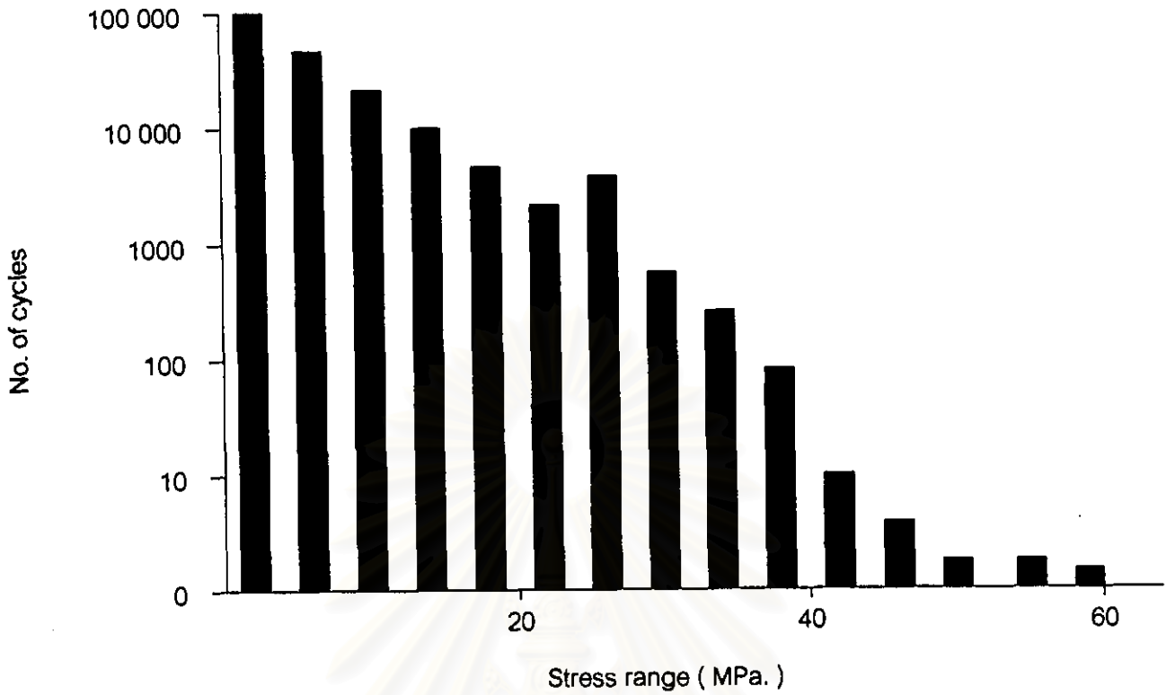
รูปที่ 2-3 แผนภูมิแท่งสำหรับจำนวนรอบในแต่ละค่าของความเค้น (stress histogram)
