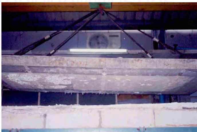
รูปที่ 3.75 การหลุดร้อนหลังการทดสอบความสามารถทนไฟ ของแผ่นพื้นชั้นที่ 1 (ลดระยะห่างเหล็กเสริม)
