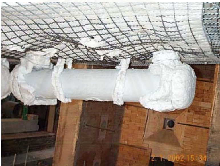
รูปที่ 4.2 การทดสอบต่อเหล็กขนาด 76x4.0 มม. ทาสีทนไฟหนา 1600 ไมครอน
