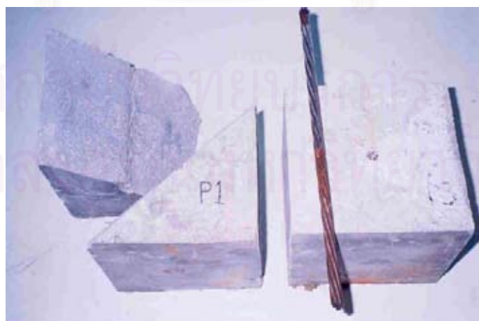
รูปที่ 3.30 ผลของแรงบิดภายในที่เกิดขึ้น ขณะทำการทดสอบกำลังยึดเหนี่ยวของวัสดุเกราท
