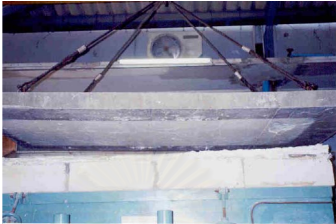
รูปที่ 3.76 การหลุดร่อนหลังการทดสอบความสามารถทนไฟ ของแผ่นพื้นที่ 2 (เพิ่มระยะหุ้มท่อร้อยลวดเกลียว)
