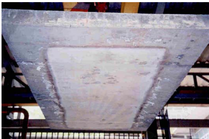
รูปที่ 3.79 การหลุ่ร่อนหลังการทดสอบความสามารถทนไฟ ของแผ่นพื้นที่ 5 (ปรับปรุงวัสดุเกราท์)
