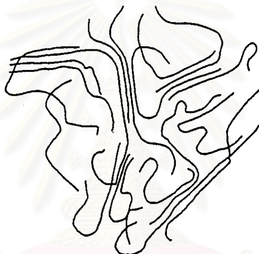
รูปที่ 2.2 โครงสร้างของพอลิเมอร์ที่เป็นผลึกบางส่วน
