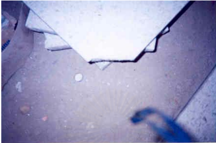
รูปที่ 4.11 การขนย้ายกระเบื้องหินขัดสำเร็จรูปที่ไม่ระมัดระวัง ทำให้เกิดการแตกหัก
