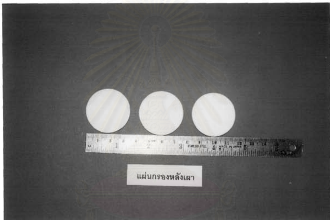
รูปที่ 4.10 แผ่นกรองซิลิกาที่ผลิตขึ้น
