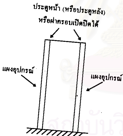
แผงสวิตช์คู่ (Dual Switchboard)
