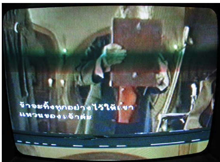
รูปที่ 5.4 ภาพแสดงผลการถอดรหัสคำบรรยายจากสัญญาณที่สร้างขึ้น และลักษณะสัญญาณ PAL 18 Closed Caption ที่ปรากฏบริเวณช่องว่างใต้ภาพ (VBI)
