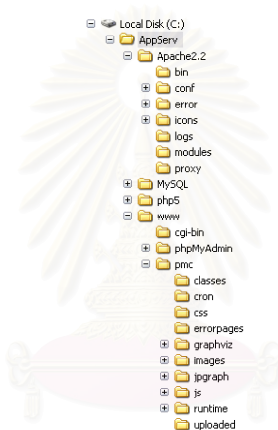
รูปที่ 3-6 โครงสร้างสารบบที่ใช้จัดเก็บโปรแกรม Apache, PHP, MySQL และไฟล์รหัสต้นทาง
