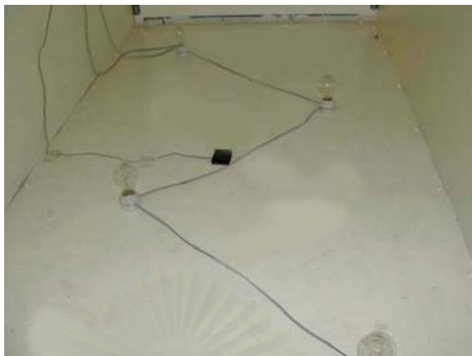
รูปที่ 3.9 ชุดหลอดไฟสร้างภาวะความร้อน
