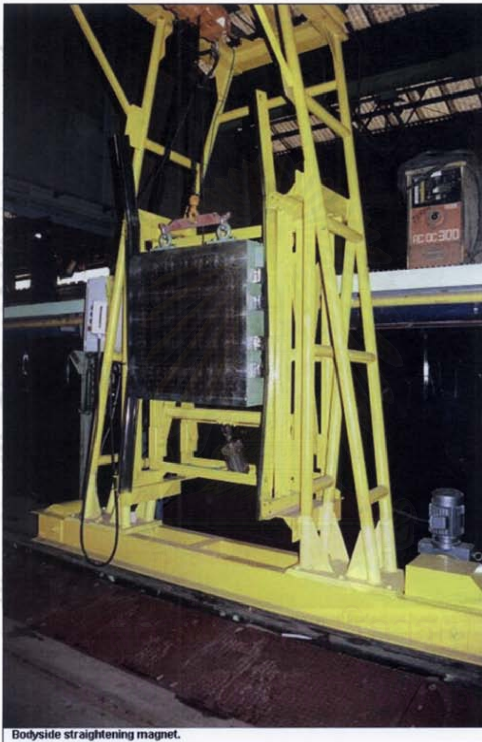
รูปที่ 5.37: การใช้แม่เหล็กในการทำให้ผนังด้านข้างของตู้โดยสารตรง
