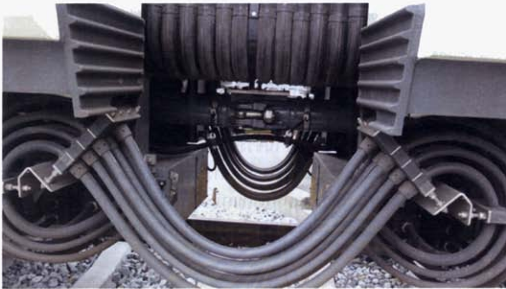
รูปที่ 5.15: coupling ที่เชื่อมต่อระหว่างตัวรถ
