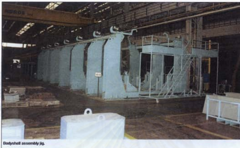
รูปที่ 5.34: แท่นจับยึดตู้โดยสารที่ใช้ประกอบผิวเปลือกนอก
