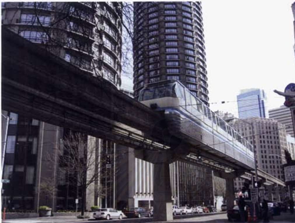
รูปที่ 3.2: รถไฟฟ้าประเภท LRT ชนิดรางเดี่ยว (monorail)
