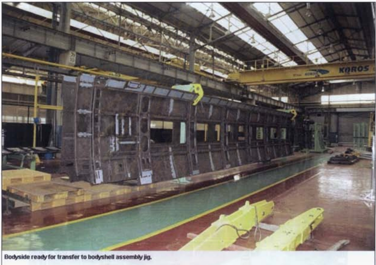
รูปที่ 5.33: ผนังตู้โดยสารด้านข้างที่พร้อมจะถูกนำไปประกอบบนแท่นจับชิ้นงาน
