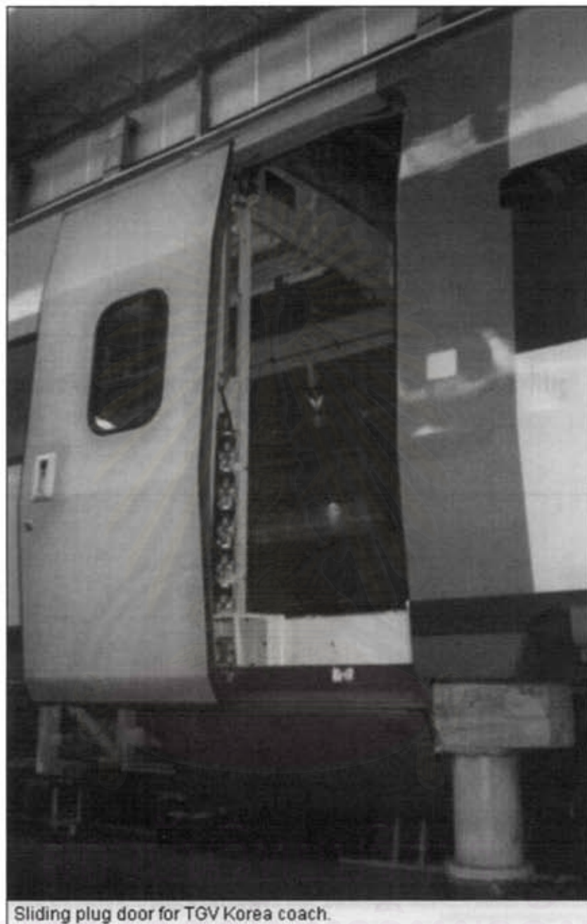
รูปที่ 5.51: แสดงการติดตั้งระบบประตู
