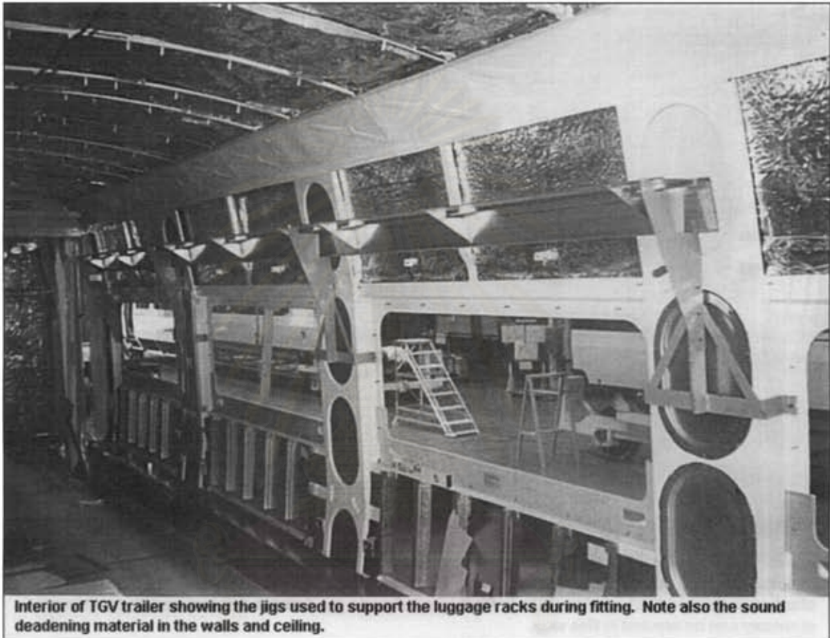
รูปที่ 5.49: แสดงการติดตั้งที่วางของโดยใช้อุปกรณ์จับยึด
