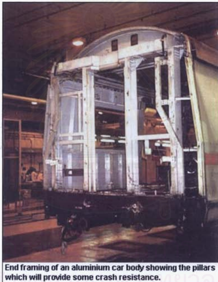
รูปที่ 5.38: ตู้โดยสารส่วนโครงสร้างด้านท้าย ที่สร้างจากอลูมิเนียม
