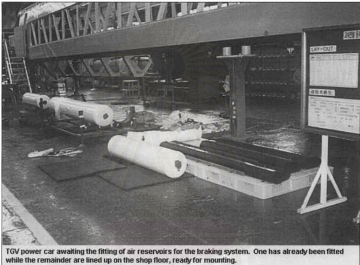
รูปที่ 5.54: ถังลมสำหรับติดตั้งในระบบลมที่ด้านใต้ของตัวรถ
