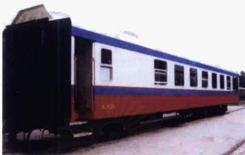
รูปที่ 6.4: Air-conditioned hard berth coach
