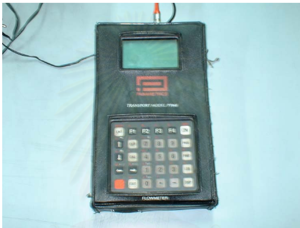
รูปที่ 7.7 มาตรฐานวัดอัตราการไหลแบบอัลตราโซนิกที่ใช้วัดอัตราการไหลน้ำในท่อน้ำเย็น
