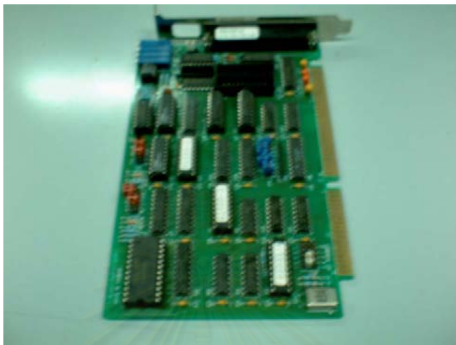
รูปที่ 7.5 การ์ดแปลงสัญญาณแอนะล็อกเป็นดิจิตอลรุ่น PA-CP12 ที่เลือกใช้
