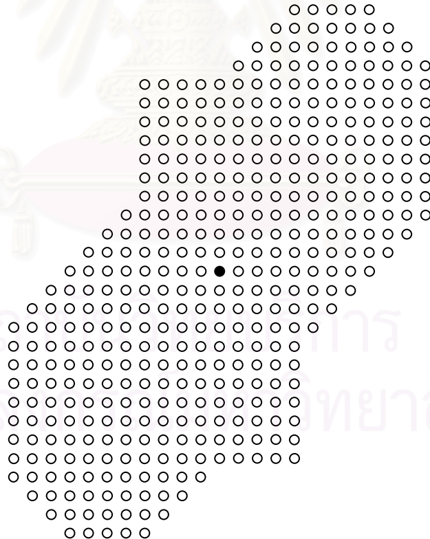
รูปที่ 3.1 ระนาบเชิงซ้อนแสดงเซตจำกัดของสถานะ Q โดยที่แต่ละสถานะใช้แทนจำนวนเชิงซ้อน x + yi โดยแกน x ในระนาบเชิงซ้อนเป็นส่วนจริงและแกน y ในระนาบเชิงซ้อนเป็นส่วนจินตภาพ จุดสีดำตรงกลางแทนพิกัด (0, 0)
