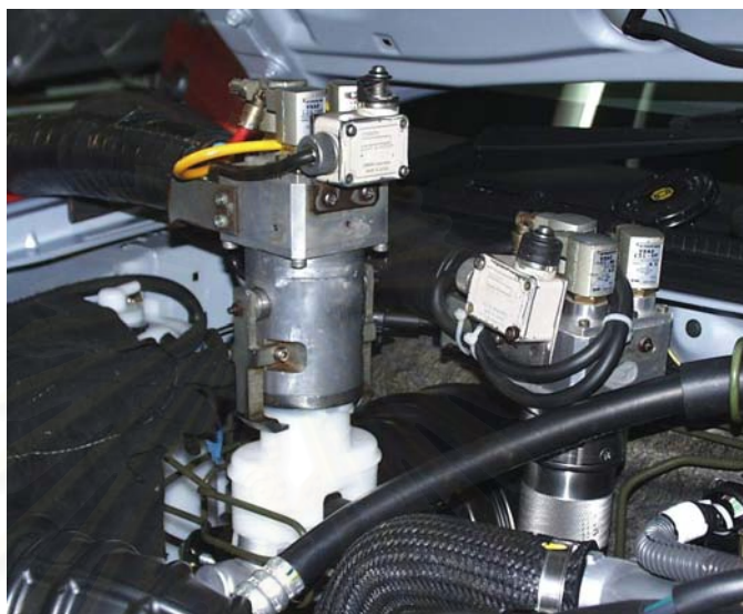
รูปที่ 4.9 ลักษณะการไถ่ลม และการเติมน้ำมันของคลัตช์ และเบรค
