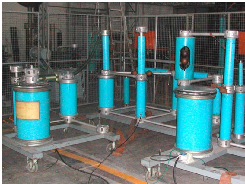
รูปที่ 4.22 วงจรทดลองการเกิดเสิร์จในระบบไฟฟ้า
