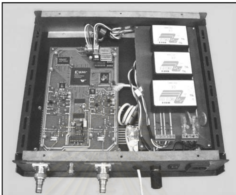
รูปที่ 3.12 เครื่องวัดและบันทึกกลุ่มคลื่นอิมพัลส์
