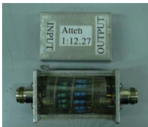
รูปที่ 3.4 ตัวลดทอนแบบความต้านทานที่ใช้ในงานวิจัย
