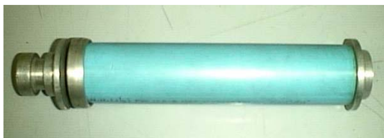
รูปที่ 3.5 ความต้านทานหนองที่พันเสร็จและประกอบเข้าท่อพีวีซี
