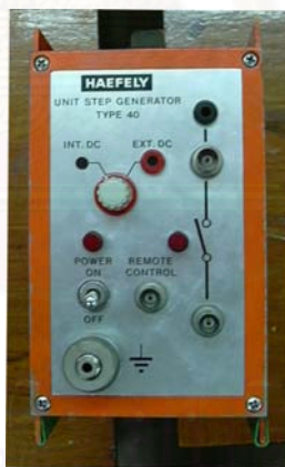
รูปที่ 3.16 HAFELY USG 40 UNIT STEP GENERATOR
