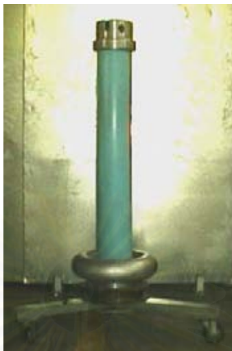
รูปที่ 3.6 โวลต์เตจดีไวเดอร์ที่ประกอบเสร็จแล้ว
