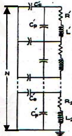
รูปที่ 2.9 วงจรสมมูลของโวลเตจดีโวลเตอร์แบบความต้านทาน
