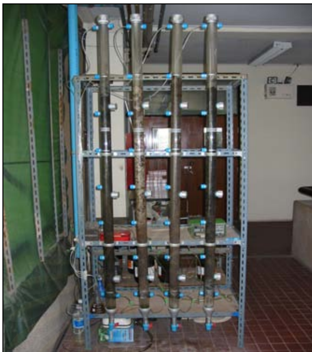
รูปที่ 3.10 ชุดทดลองเครื่องกรองชีวภาพในการศึกษาตัวกลางที่เหมาะสมในการบำบัดก๊าซไฮโดรเจนซัลไฟด์
