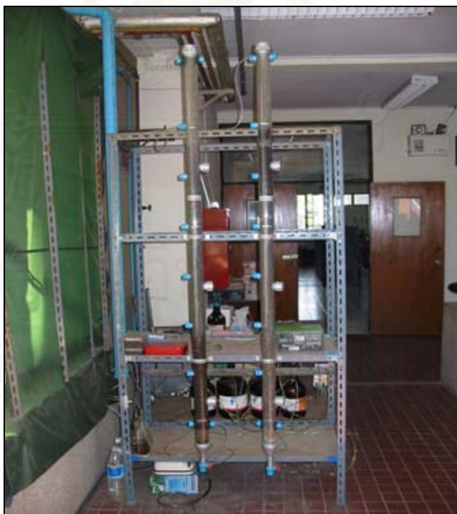
รูปที่ 3.11 ชุดทดลองเครื่องกรองชีวภาพในการศึกษาอิทธิพลของทิศทางการไหลของก๊าซไฮโดรเจนซัลไฟด์ที่มีต่อประสิทธิภาพการบำบัด
