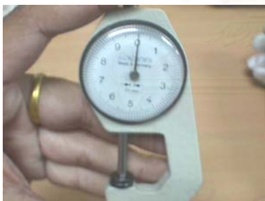
รูปภาพที่3 การตรวจพื้นผิวของนาฬิกาว่าเรียบไม่มีแสงลอด และเข็มจะต้องตรงศูนย์
