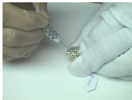
รูปภาพที่ 2 ลักษณะการเช็คการขยับของเพชรพลอย
