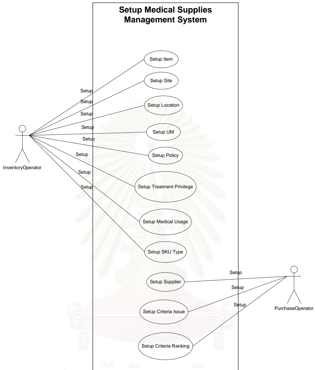
รูปที่ 3.4 Use Case Diagram ของกระบวนการบริหารเวชภัณฑ์ในส่วนของการตั้งค่า (Setup Medical Supplies Management System)
